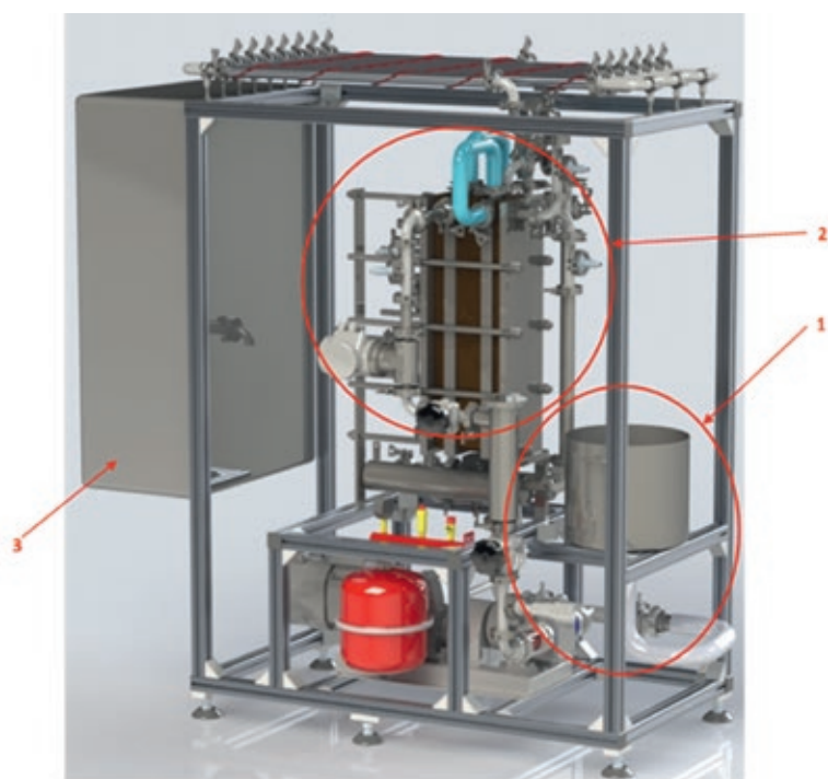
Model stanowiska badawczego pasteryzatora jaj: 1 – surowiec, 2 – sekcja podgrzewania, 3 – szafa sterownicza (źródło: opracowanie własne)
